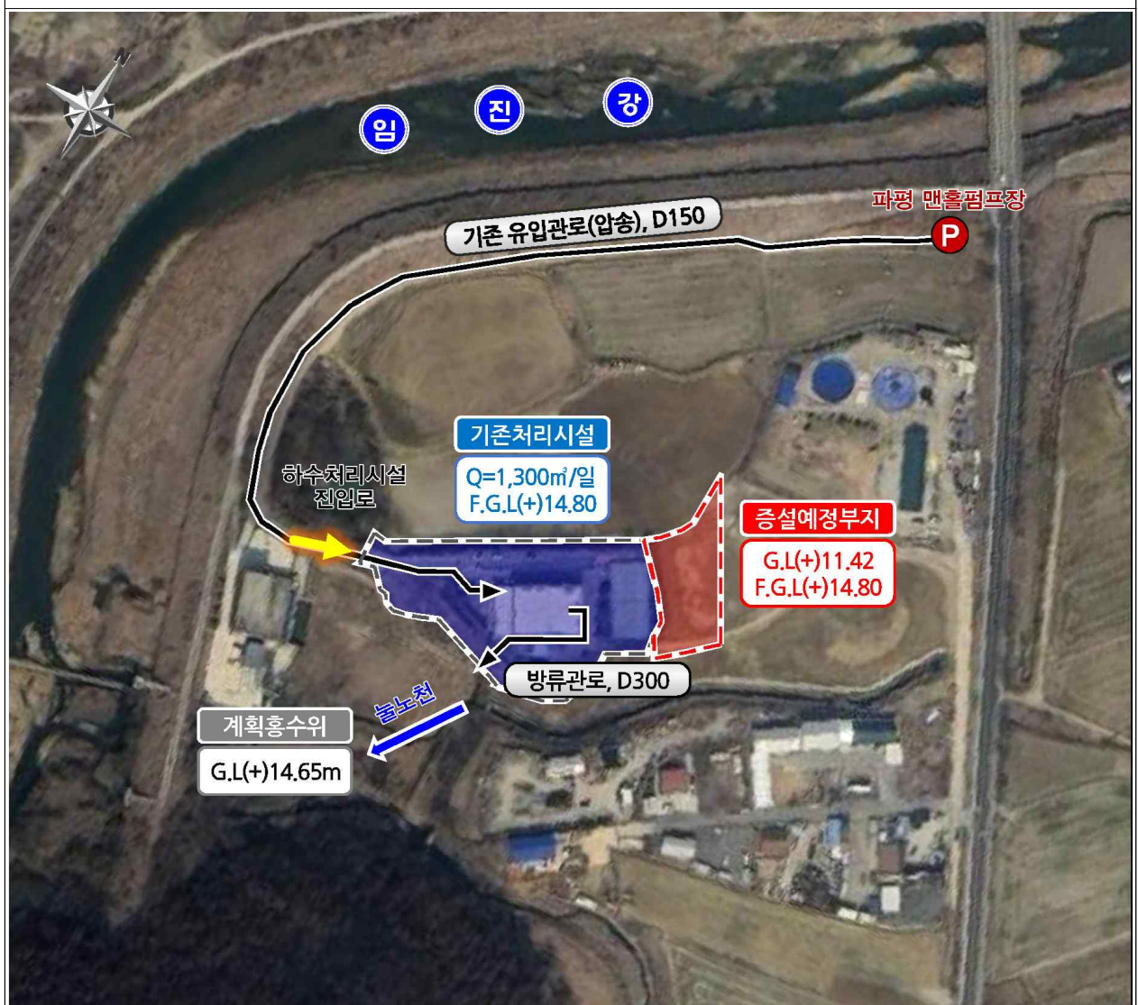
기존 하수처리시설 평면도 및 증설 예정부지 위치도
